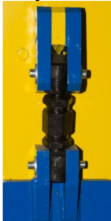
Рис. 2. Талреп (устройство регулировки глубины подачи ножей).
